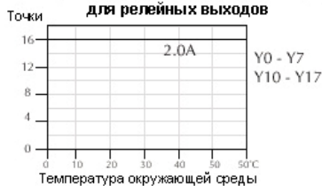
График снижения номинальных характеристик в зависимости от температуры для релейных выходов
