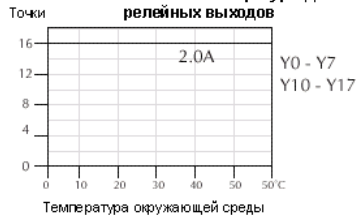
График снижения номинальных характеристик в зависимости от температуры для релейных выходов
