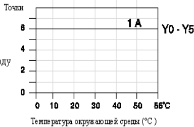
График снижения номинальных характеристик в зависимости от температуры для выходов постоянного тока
