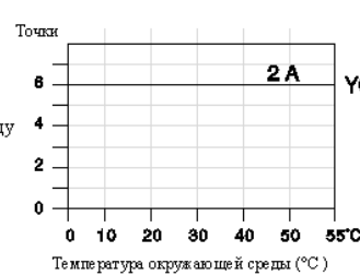
График снижения номинальных характеристик в зависимости от температуры для релейных выходов
