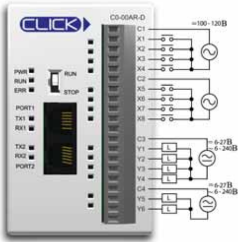
Эквивалентная схема входов
