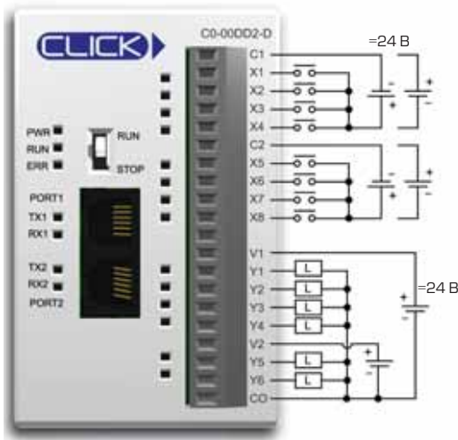
Эквивалентная схема входов
