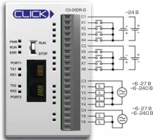
Эквивалентная схема входов
